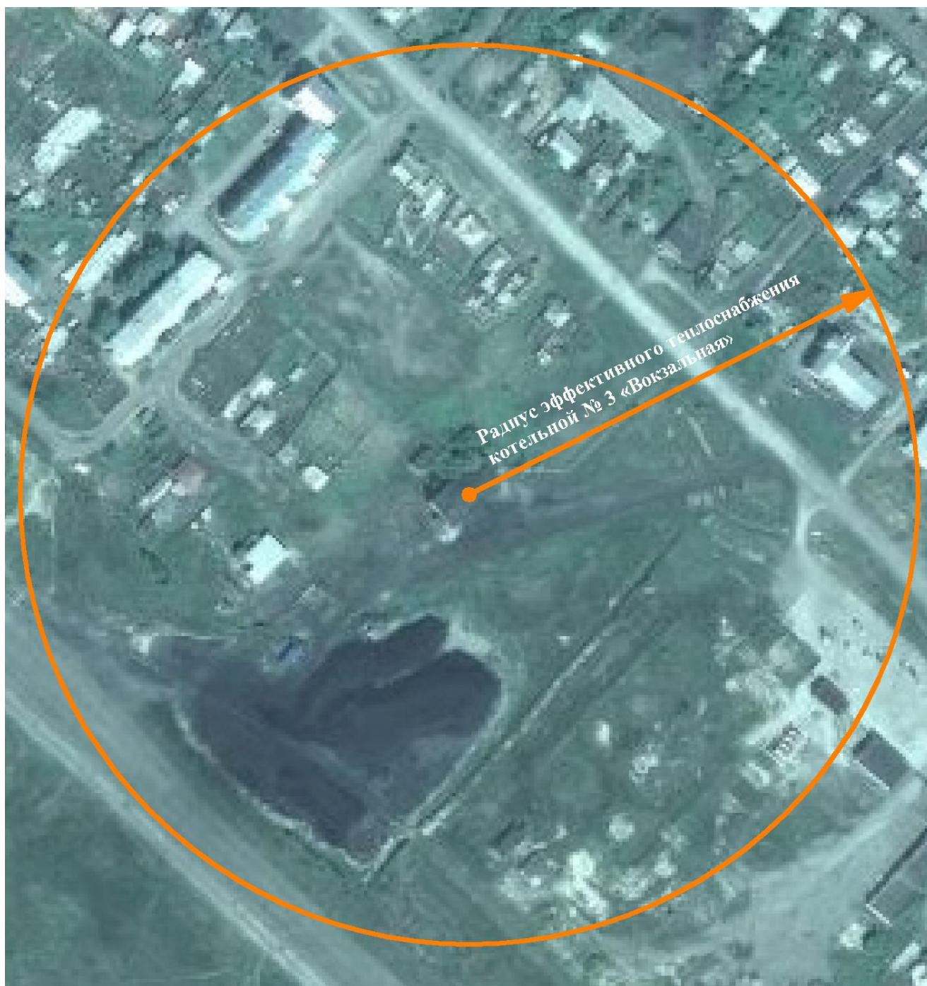
Рисунок 2.2 – Радиус эффективного теплоснабжения Котельной № 3 «Вокзальная»
