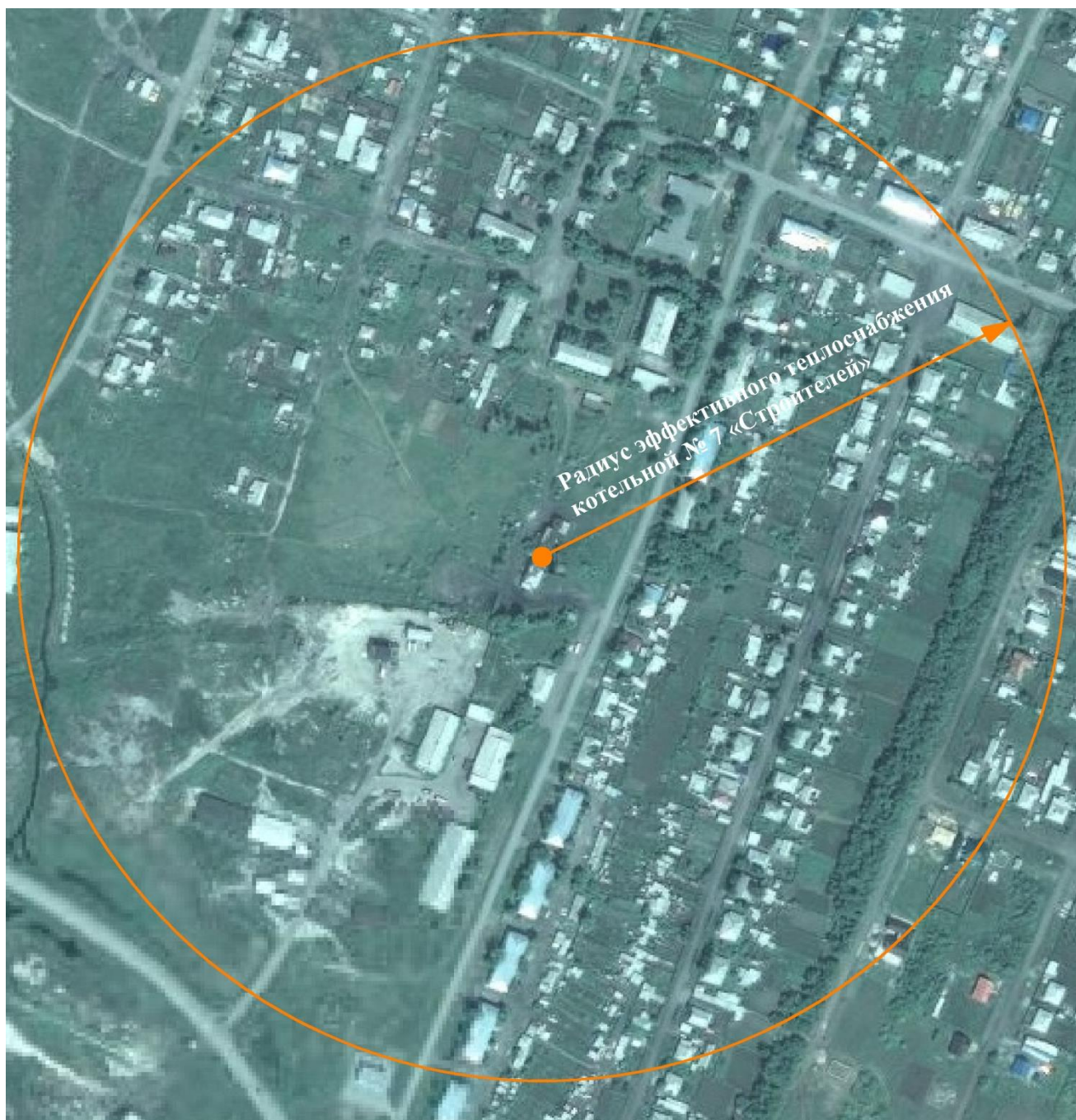
Рисунок 2.6 – Радиус эффективного теплоснабжения Котельной № 7 «Строителей»
