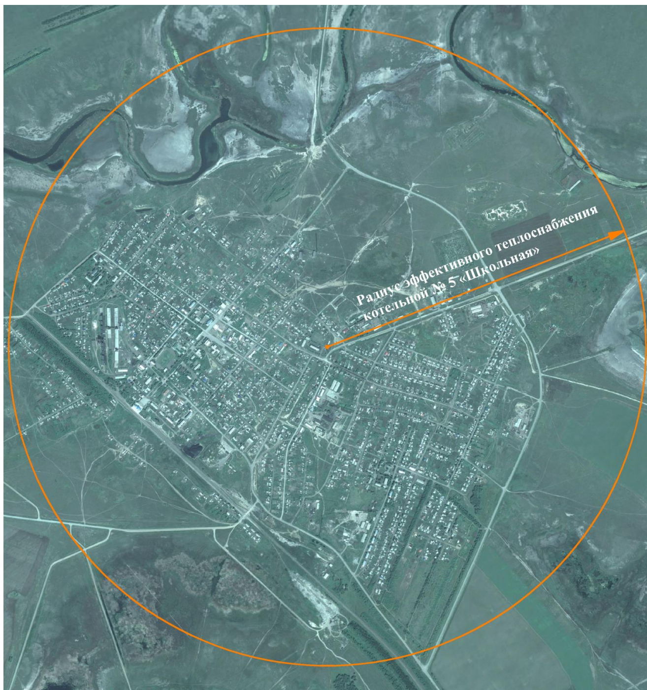
Рисунок 2.4 – Радиус эффективного теплоснабжения Котельной № 5 «Школьная»
